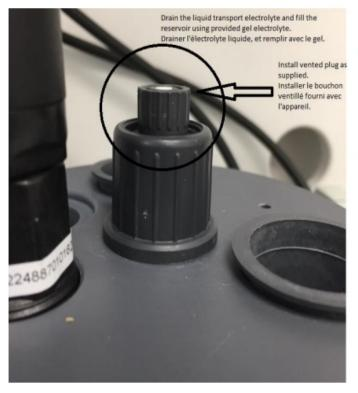
Drainer l'électrolyte liquide et remplir le réservoir central avec l'électrolyte en gel (bouteille fournie). Installer le bouchon ventilé.
