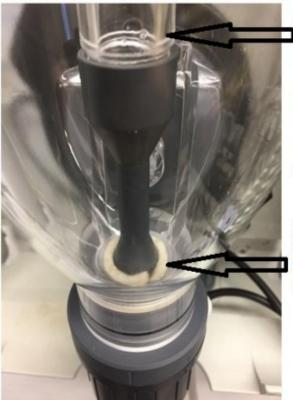
Remove top Yellow plug and discard. Drain liquid electrolyte and replace with Gel electrolyte solution. Enlever et jeter le bouchon jaune. Vider l'électrolyte de transport, et remplir avec la solution d'électrolyte en gel fournie.
