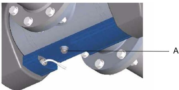
Image 2 Coupe chambre de rayonnement avec vis de vidange en cas de montage horizontal
