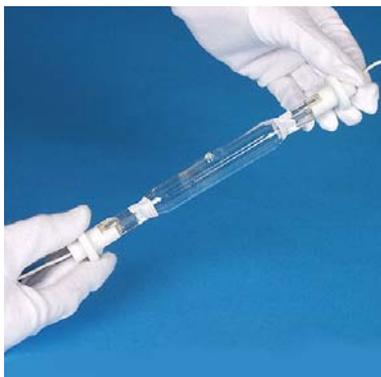
**18** Remettre la lampe en place. Enfiler pour cela les gants en coton fournis. Ne pas toucher la lampe les mains nues ! Nettoyer le verre avec le chiffon de nettoyage fourni (n° de référence AAE2971). Ne pas tenir la lampe par un seul côté. Le tenir par ses extrémités.
