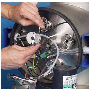
**20** Connecter les fils de connexion sur les bornes. Presser pour cela le ressort le plus possible vers le bas avec un tournevis en fente jusqu'à ce que le fil puisse être introduit dans le point de serrage.
