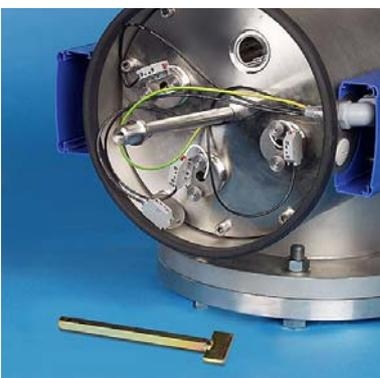
**13** Ôter la vis de fermeture des deux côtés à l'aide de la clé en T fournie.
