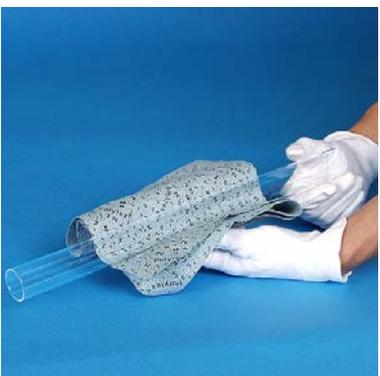
**15** Nettoyer le tuyau de gainage avec de l'alcool ou le changer.
